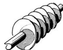
Испаритель с ребристыми трубами
