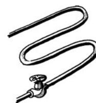
Испаритель с простыми трубами
