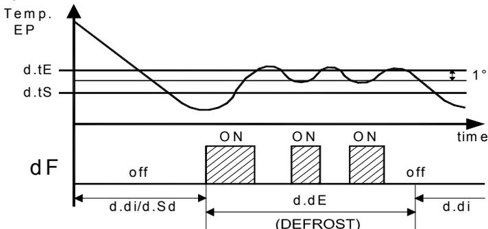
Пример электрического размораживания температурой: размораживание заканчивается по истечению времени
