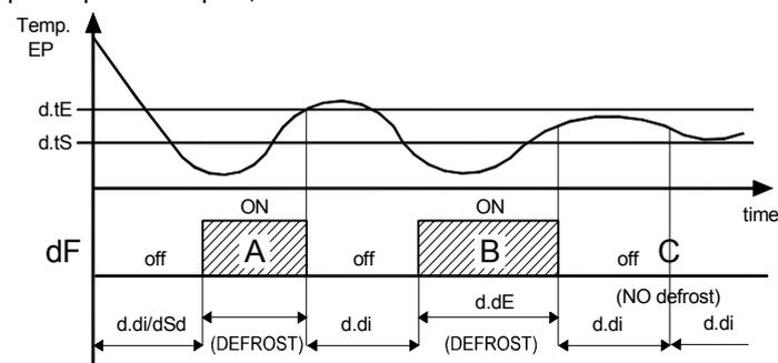
Примеры окончания разморозки: размораживание A заканчивается по достижению температуры "d.tE", размораживание B заканчивается по истечению времени "d.dE", и так как температура "d.tE" не достигнута, размораживание C не запускается пока температура превышает "d.ts".
