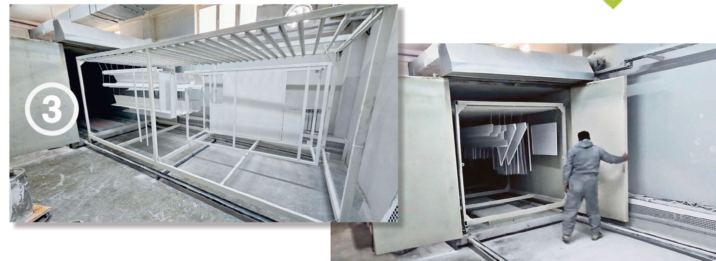
Ұнтақпен қаптау полимерлеу пеші / Печь полимизации порошковой покраски / Powder coating polymerization oven
